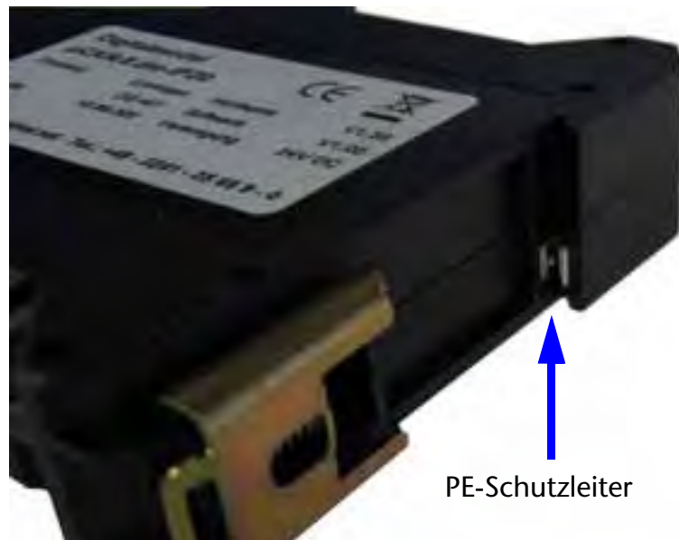
Abb. 5: Einspeisung des PE-Schutzleiters
